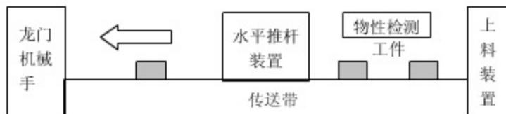
生产过程中，工件经间歇式上料装置依次放置在输送带上，输送带在电动机的驱动下将工件向前输送。工件经传感器检测后，金属工件经水平推杆装置推出，非金属工件则通过机械手转运至指定工位供下道工序加工。
