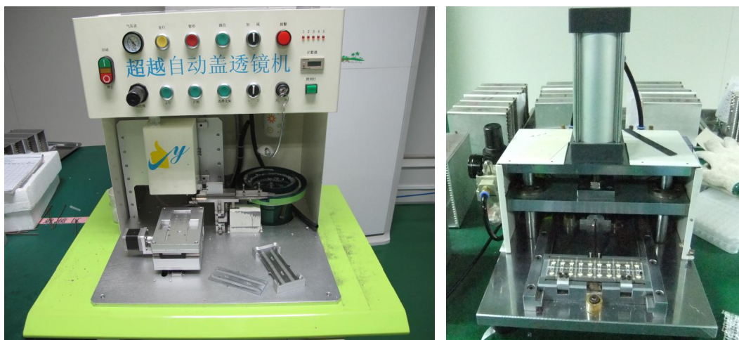
图 3.9 自动盖透镜机 左：分立型 右：透镜片型
