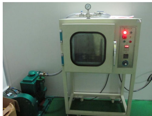
图 3.5 配胶子工序之抽真空机
