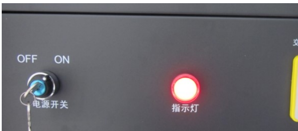
图 5.7 系统柜电源开关
