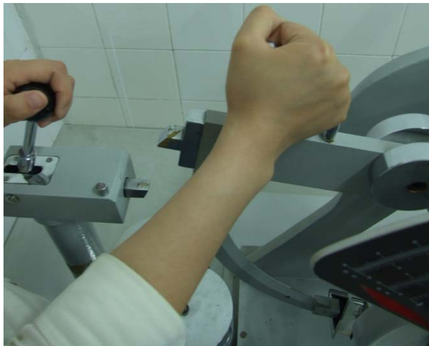
图 1-27 摆轴摩擦力的校准
