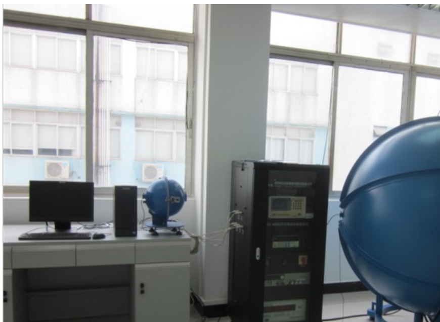
图 5.1 LED 光色电综合测试系统
