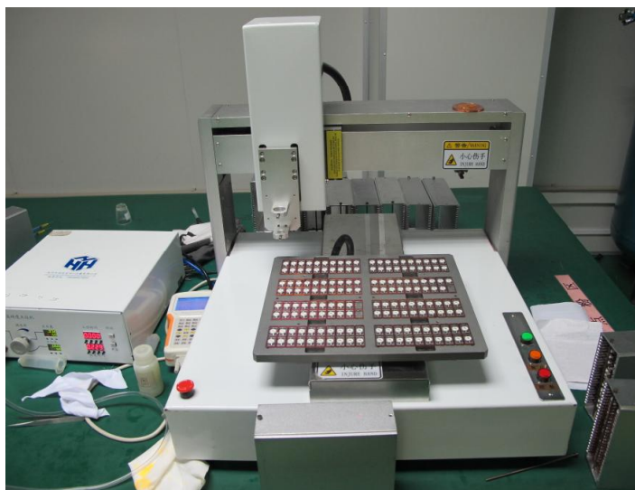
图 3.6 分立仪器型自动点胶机
