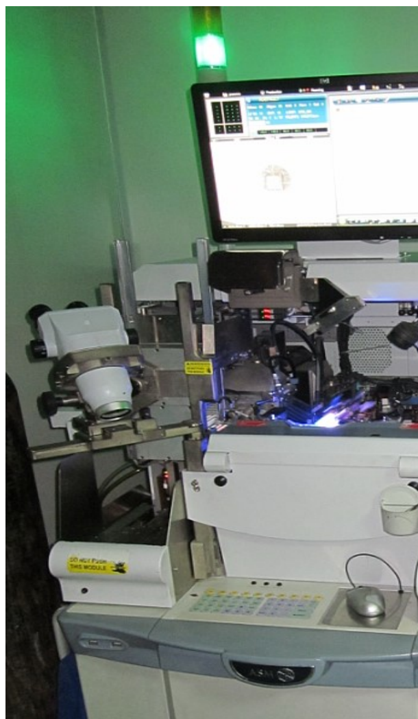
图 2.1 ASM 自动焊线机
