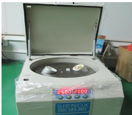
图 3.4 配胶子工序之搅拌（自动搅拌机）
