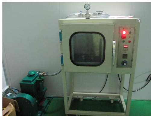
图 3.5 配胶子工序之抽真空机
