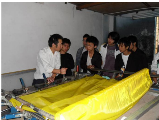
图 14 金田包装有限公司兼职教师吴远斌讲解丝印绷网工艺
