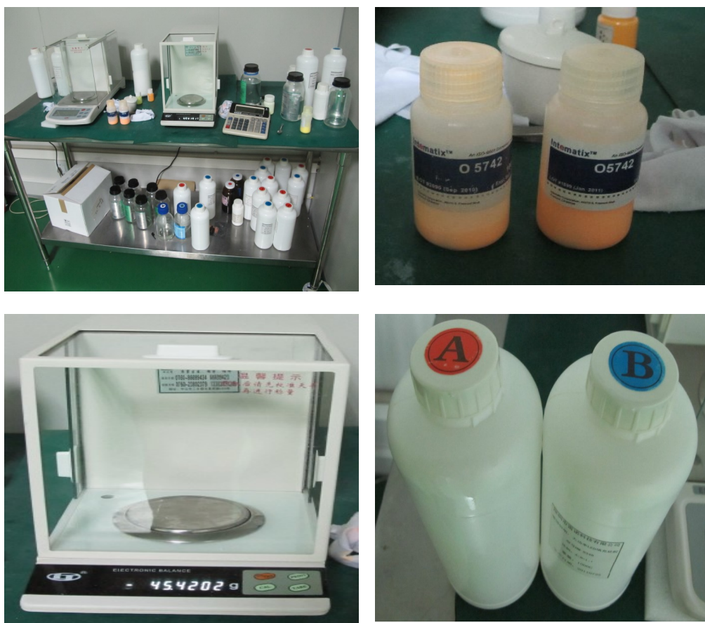
图 3.3 配胶子工序之电子天平称量物料
