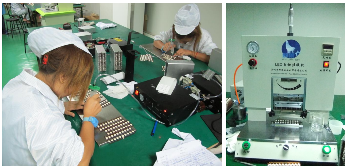
图 3.11 灌胶设备与操作 左：手动 右：自动
