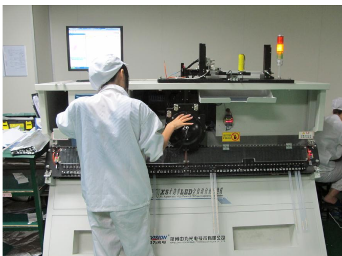
图 4.2 大功率 LED 自动分光机
