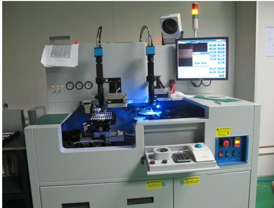
图 1.2 晶驰高速自动固晶机
