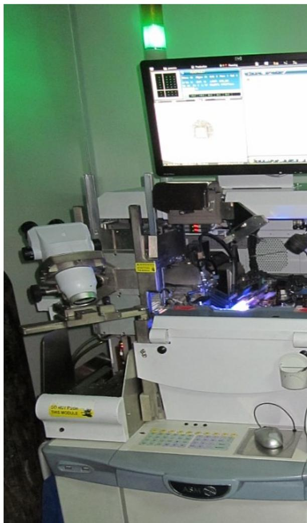
图 2.1 ASM 自动焊线机
