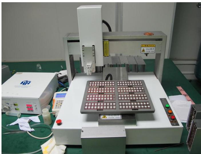
图 3.6 分立仪器型自动点胶机
