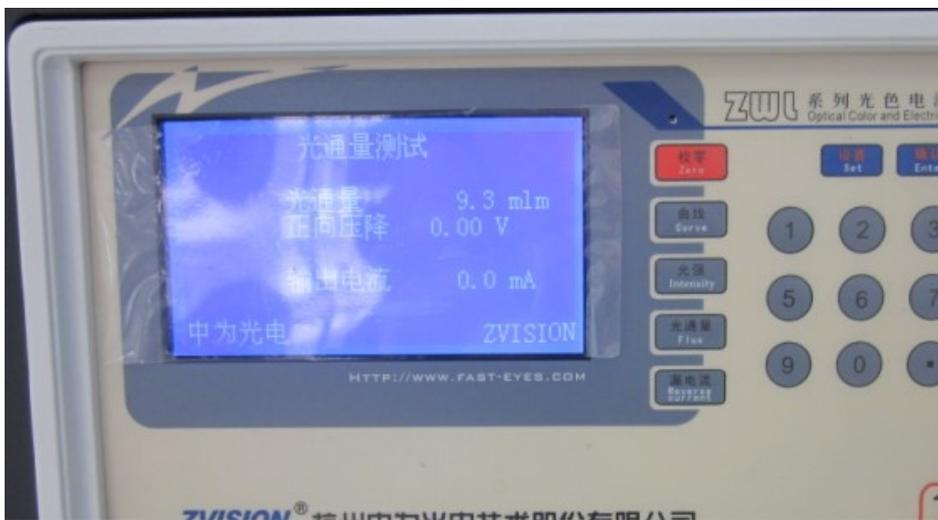
如上图所示，前面板上的快捷键有“设置”、“确认”、“←”、“校零”、“光强”、“光通量”、“漏电流”、“曲线”以及数字键和电源开关按钮。
