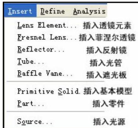
若选择插入透镜，Insert> Lens Element，主要要点：1) 透镜材料选择；2) 透镜参数设置；3) 透镜的位置设置。
