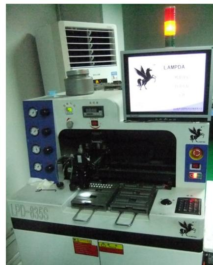
图 3.7 整体机器型自动点胶机
