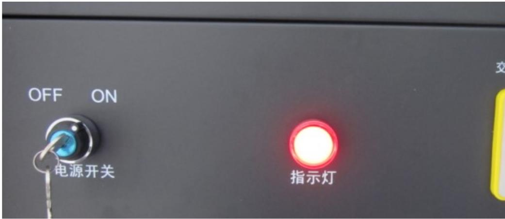
图 5.7 系统柜电源开关
