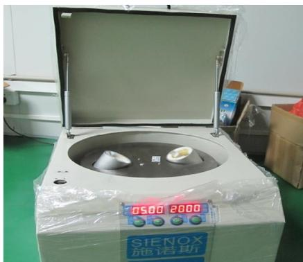
图 3.4 配胶子工序之搅拌（自动搅拌机）
