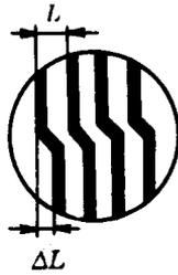
图 2.2.4-37 在薄膜台阶处干涉条纹的位移
