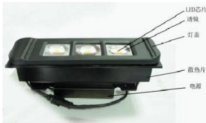
图 14 LED 隧道灯结构外形
