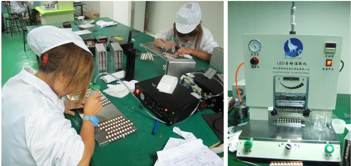
图 3.11 灌胶设备与操作 左：手动 右：自动
