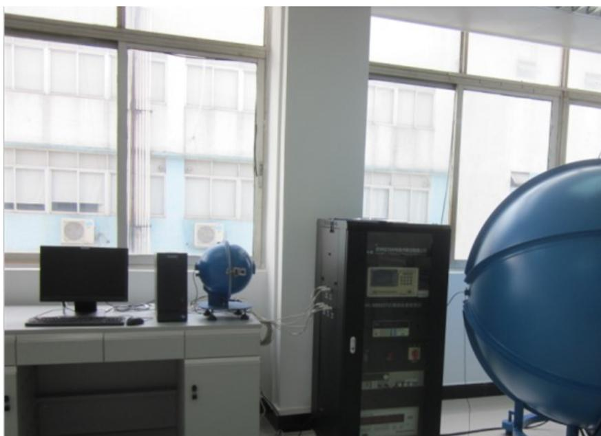
图 5.1 LED 光色电综合测试系统
