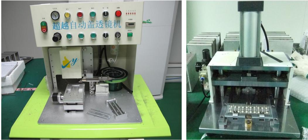
图 3.9 自动盖透镜机 左：分立型 右：透镜片型
