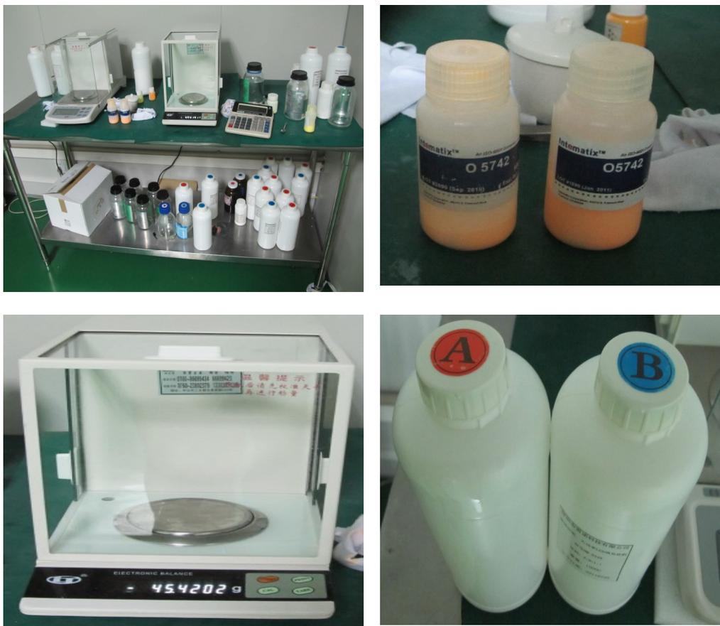
图 3.3 配胶子工序之电子天平称量物料
