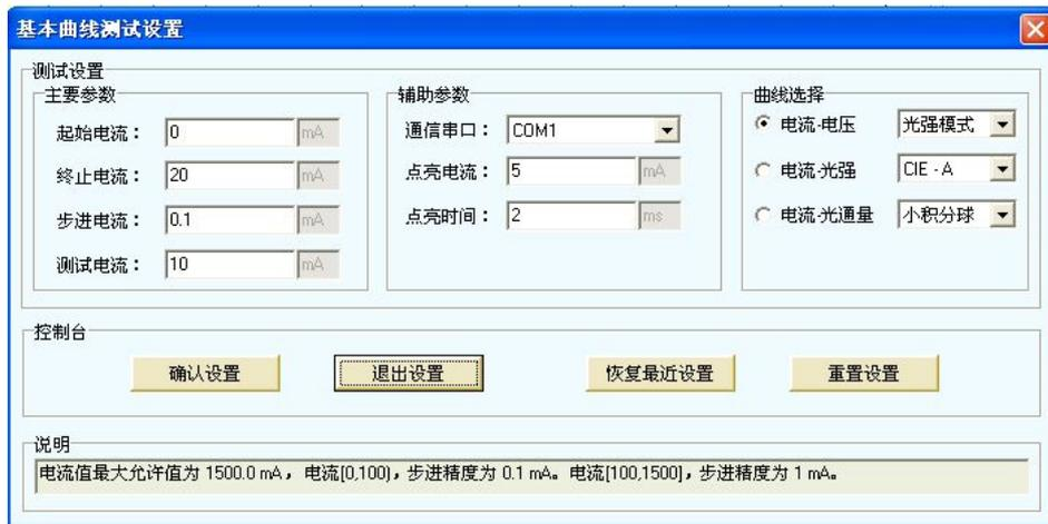
完成所有参数设置后，点击“确认设置”，即完成测试设置，设置的参数值显示到基本曲线的显示界面上。
