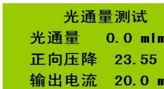
在测试界面下按“←”键清除当前电流值，再按数字键输入需要的电流值，最后按“确认”键使设置生效。本仪器可任意设定输出电流值（输出范围 0~1500mA），以适应不同的测试项及不同的灯具的测试需要。
