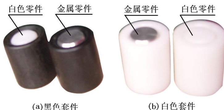
图 1 已完成装配和压紧加工的工件
