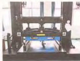
上货架抗弯测试（长方向）
