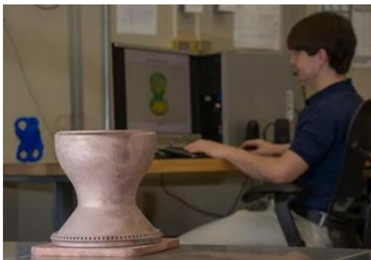
图 2-8 NASA3D 打印第一个全尺寸铜发动机零件
