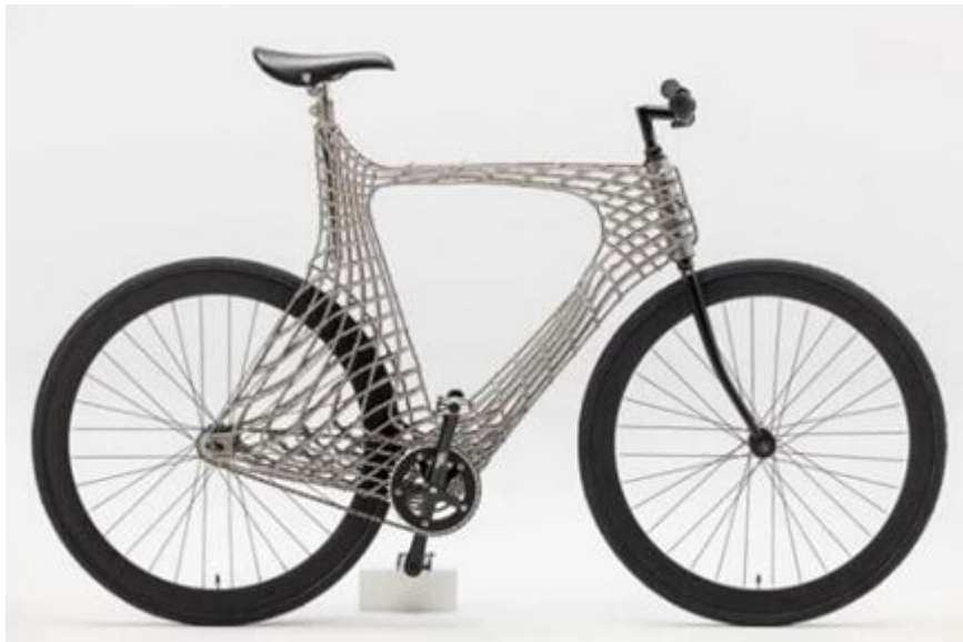
图 2-5 用 MX3D 公司技术 3D 打印的自行车钢骨架
