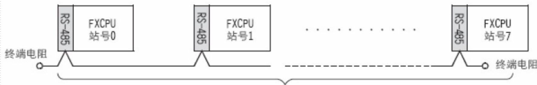
图4-13 N：N通信结构图
