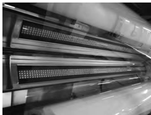
图6 UV-LED固化装置
