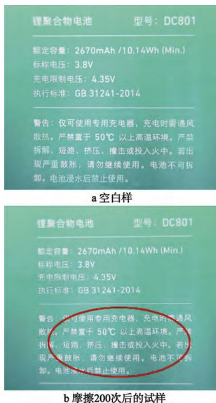
图 2 耐磨性测试结果
