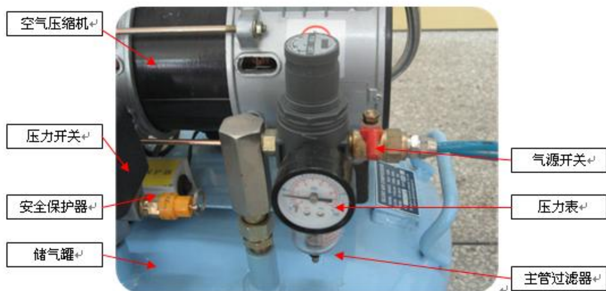
图 2-45 气泵上的元件介绍
