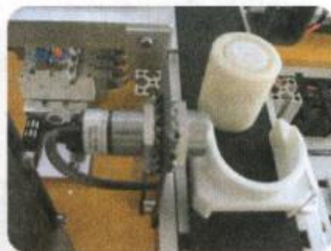
(c) 光电开关没有检测到工件
