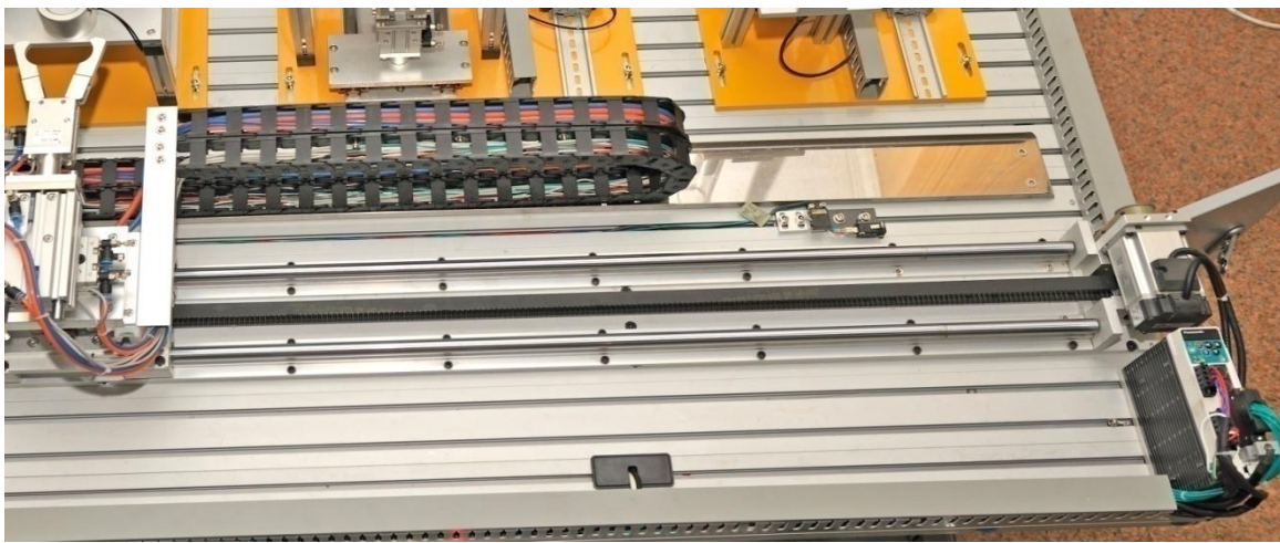
图2-32 YL-335B的输送单元上的伺服电机及驱动器
