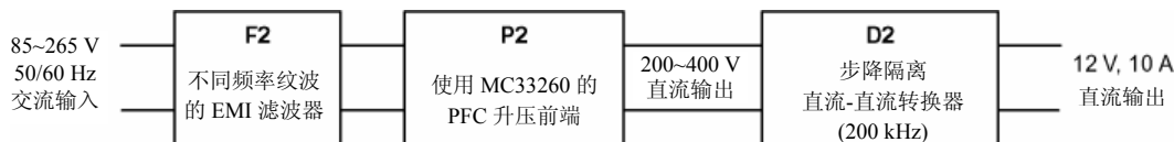
图22. 带可变输出电压的临界导电模式PFC
