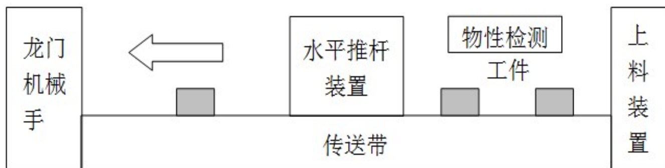
图 3-1 自动分拣线的结构简图
